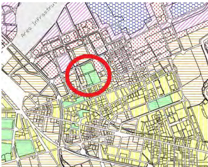
Figura 1: accostamento critico di Corso Trieste nell'area universitaria con accostamenti tra classe I e classi III/IV.
